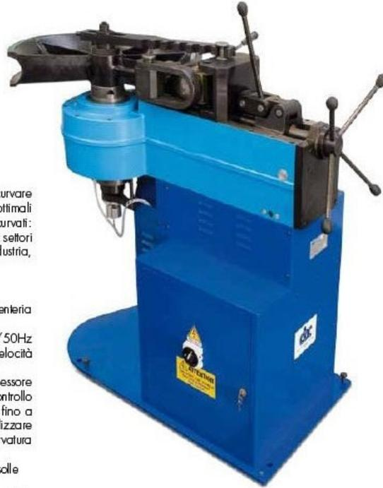
■ UNI 89, una curvatubi potente e precisa per curvare tubi di grande diametro. I raggi di curvatura ottimali e costanti non deformano in alcun modo i tubi curvati: ideale per le varie esigenze degli operatori nei settori dell'idraulica, nautica, oleodinamica, industria, impiantistica in genere.
